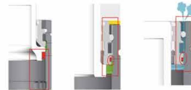
每个氮气弹簧有固定的使用行程，建议客户使用不超过最大90%的行程，当客户的实际使用行程超过产品设计使用的最大行程时，导向套继续往下运动，密封件超过最大压缩极限，就无法密封，瞬间造成产品的漏气，从而保护及人员避免受到的伤害。
